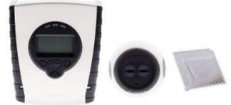
Son fonctionnement est basé sur le phénomène d'absorption selon la loi « Lamben-beer » (affaiblissement d'un rayon). Un faisceau infrarouge (invisible) entre l'émetteur/récepteur et le réflecteur, analyse l'opacité de l'air ambiant ; une valeur de 25 à 50 % d'opacité sera analysée comme une alarme ; une obstruction totale déclenchera un dérangement. « FIRERAY5000 » **est particulièrement approprié à des locaux de grand volume** tels que les atriums, les stockages de grande hauteur, etc. ...
